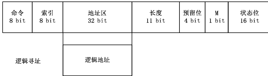
EtherCAT 逻辑寻址结构
